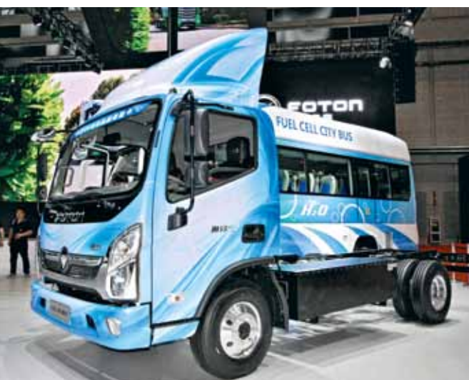
Foton Ollin на электротяге. Силовая установка состоит из литий-ионных батарей емкостью 83,2 кВт·ч и электродвигателя мощностью до 100 кВт. На одной зарядке грузовик способен проехать до 260 км при максимальной скорости 90 км/ч
