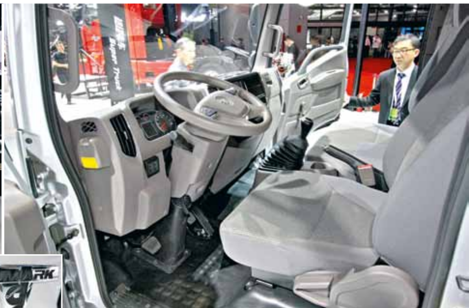
↓ Foton Aumark четвертого поколения (M4). На выставке была представлена модификация S1 полной массой шесть тонн с колесной базой 3360 мм. В РФ планируются поставки машин полной массой 6,5 и 8,0 т
