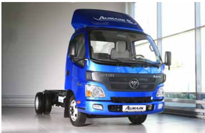
Самый легкий Foton Aumark BJ1039 грузоподъемностью 1,56 т оснащен турбодизелем Cummins объемом 2,8 л (Евро-4) мощностью 105 л.с. и крутящим моментом 280 Нм. Коробка передач - 5-ступенчатая производства ZF. На шасси может быть смонтирован кузов длиной 3,2 – 4,6 м.
