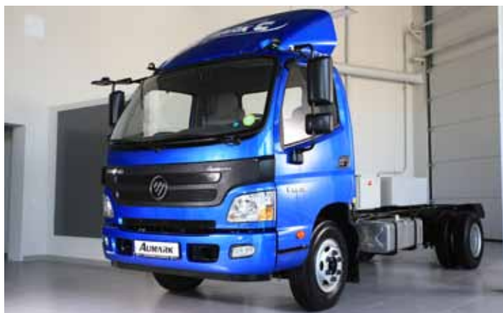
Самый мощный Foton Aumark BJ1089 полной массой 8,2 т и грузоподъемностью около 5 т, оснащается турбодизелем Cummins 3.8 ISF (Евро-4), который выдает внушительные 152 л.с. и 500 Нм. и 6-ступенчатой механической. Длина кузова от 5,2 до 6,2 м.
