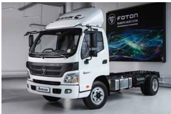
Трехтонный Aumark BJ1069, (техническая грузоподъемность — 3 385 кг) оснащается двигателем Cummins 3.8 ISF (143 л.с. 450 Нм), выполняющим нормы Евро-4. Шасси позволяет устанавливать кузова длиной до 5,2 м.
